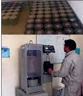
**PERAWATAN DAN PENGUJIAN BENDA UJI SILINDER BETON**
