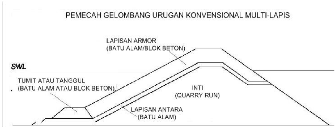
Gambar II.F.25 Pemecah gelombang urugan multi-lapis konvensional
