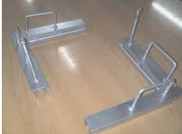
Kategori Teknologi Tepat Guna : Ganjal Celah Vertikal Antara Bekisting dengan Besi Kolom Pengaju Karya : PT Total Bangun Persada, Tbk.
